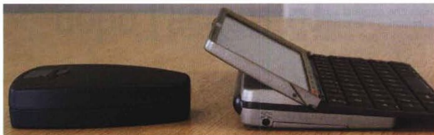
Il Travel Modem si "collega" via raggi infrarossi a tutti gli Psion e permette sia l'utilizzo di una linea telefonica tradizionale che l'interfacciamento a telefoni cellulari GSM.
